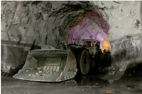
A RCT instalou seu ControlMaster® Automação Guidance em várias máquinas, incluindo esta CAT 2900 carregadeira subterrânea da MATSA na Espanha.
