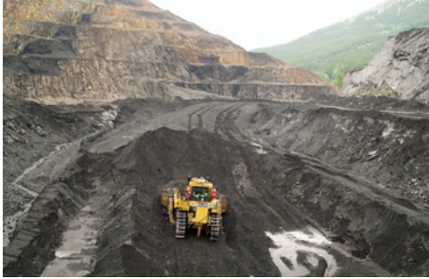
A tecnologia ControlMaster® de Telemote da RCT foi instalada nessa CAT D11T bulldozer da Teck Resources Coal Mountain Operations, no Canadá.
